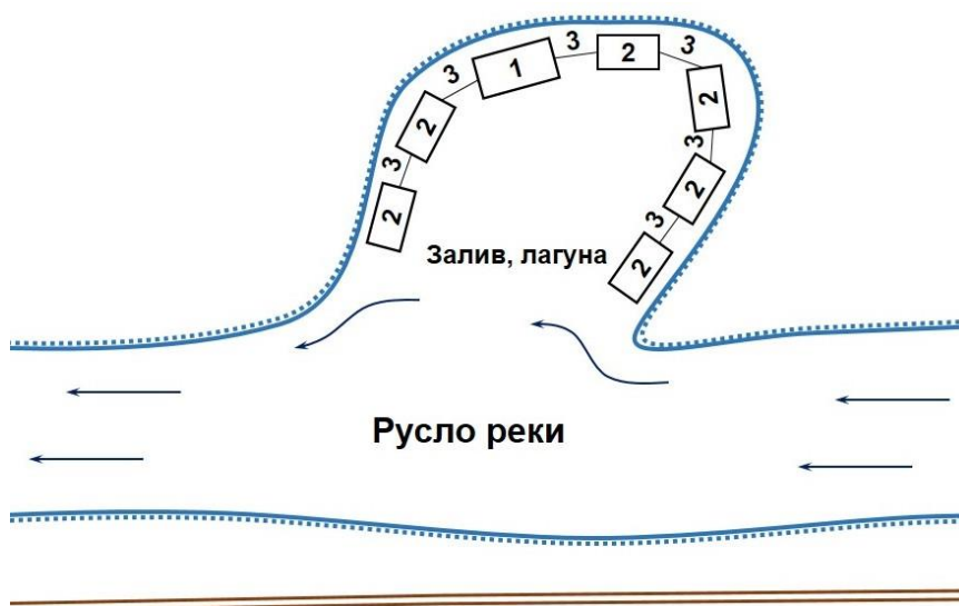
Рис. 1. План размещения технологического комплекса по производству аквакультуры-раки в заливе-лагунае реки (например, реки Волги)
