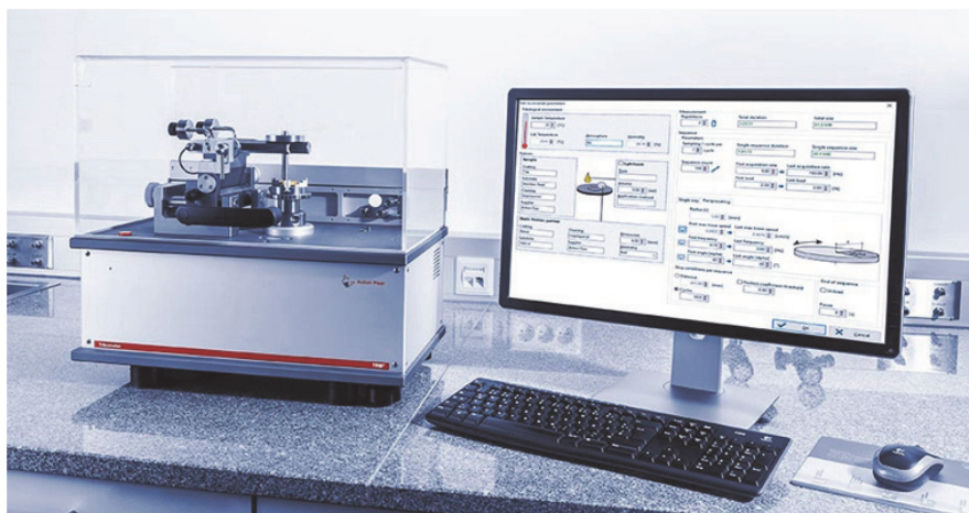
Рис. 1. Внешний вид установки Tribometer TRB
