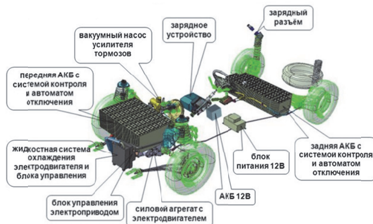
Рисунок 1 – Устройство электромобиля
