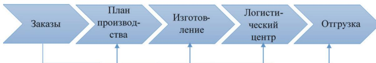
Рис. 4 — Укрупненное представление связей внутри системы организации производства после ввода логистического центра
