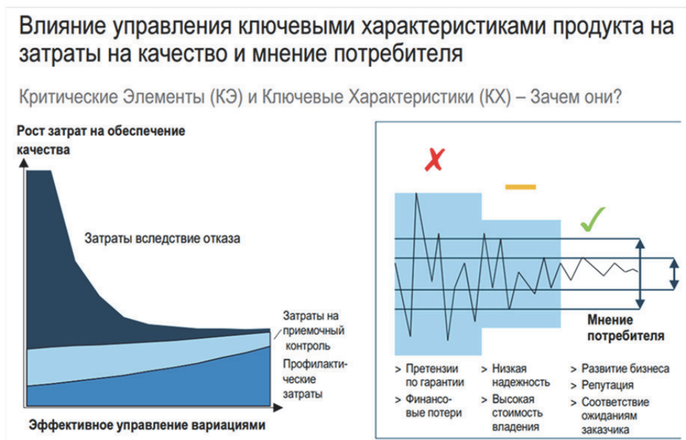
Рисунок 1 – Графическая интерпретация подхода по определению ключевых характеристик новой конструкции автомобиля
