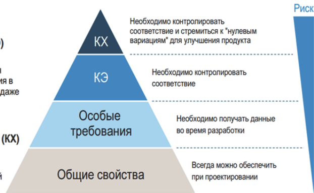
Рисунок 6 – Пирамида менеджмента в вопросах управления критическими характеристиками и ключевыми элементами продукции в процессе проектирования
