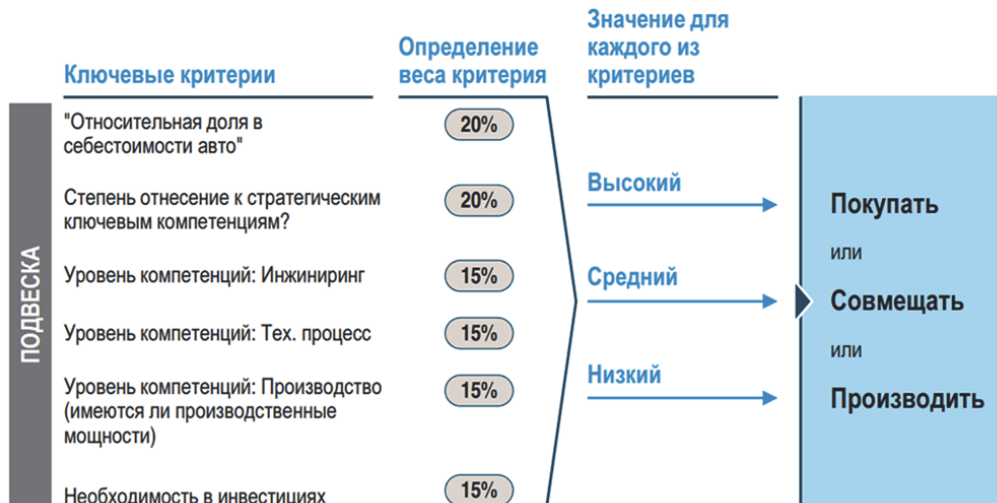
Рисунок 11 – Пример шаблона по выбору ключевых характеристик и элементов продукции на стадии проектирования
