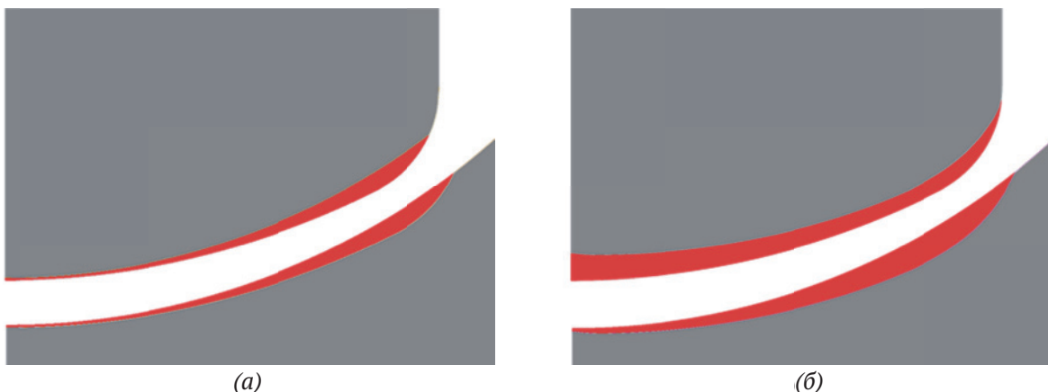
Рис. 4. Профиль износа: (а) – при постоянной твердости, (б) – при твердости, зависящей от радиальной координаты
