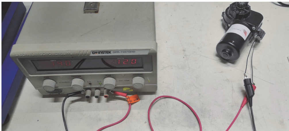
Рисунок 6 – Проверка сохранения работоспособности образца при напряжении питания 12 В
