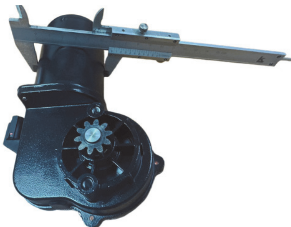
Рисунок 4 – Замер наружного диаметра корпуса двигателя
