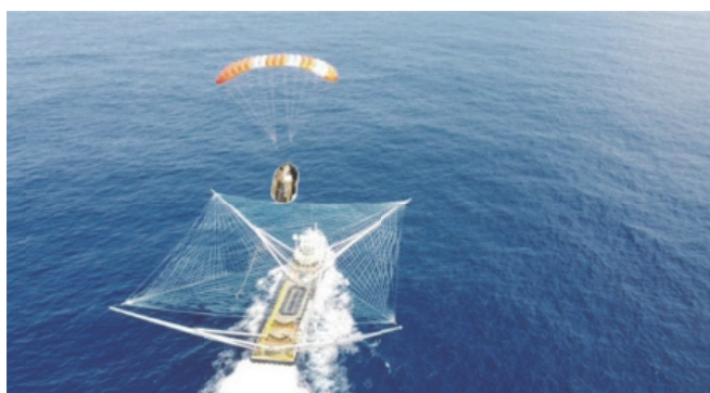
Рис. 2. Фрагменты отработки технологии возврата головного обтекателя:
