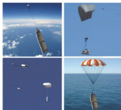
Рис. 2. Фрагменты отработки технологии возврата головного обтекателя:
