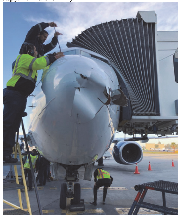
Рисунок 2 – Последствия столкновения БВС с носовым обтекателем Boeing 737-800
