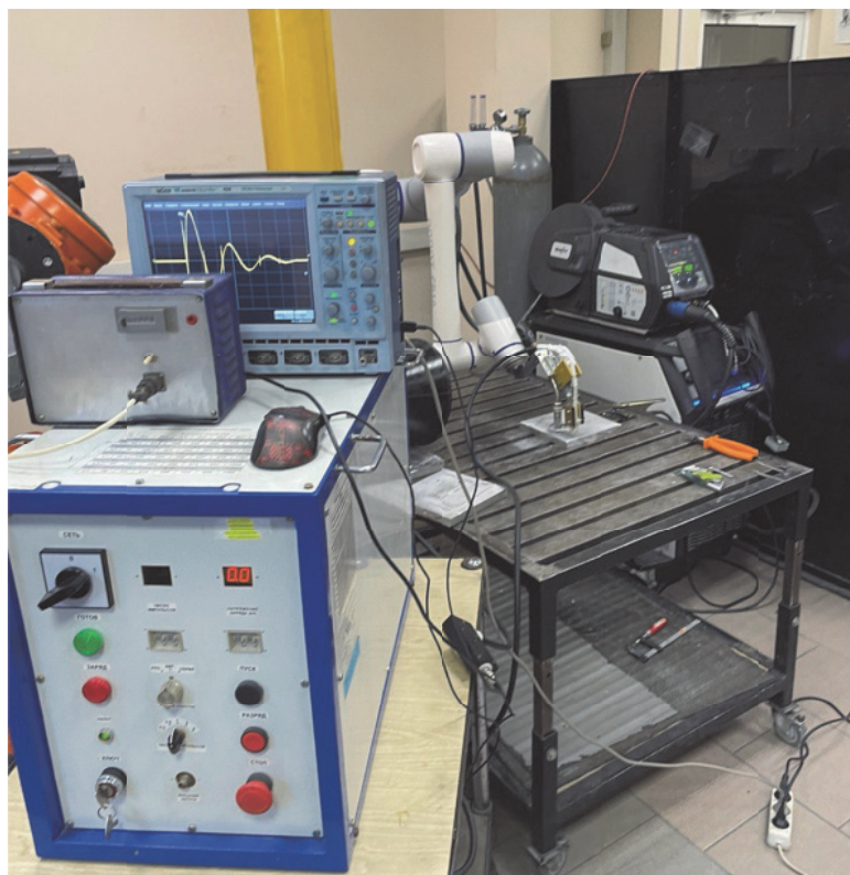
Рис. 6. Общий вид комплекса для совмещенного процесса «электродуговая наплавка - магнитно-импульсная обработка»
