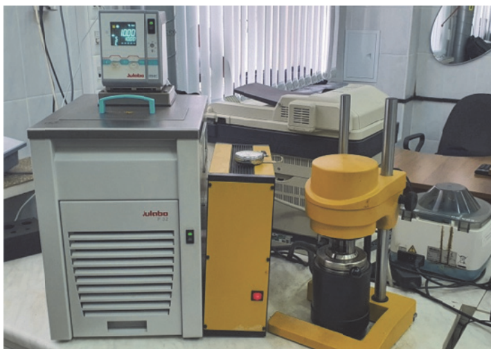
Рис. 1. Оборудование для определения реологических свойств отобранных образцов шламов в лабораторных условиях
