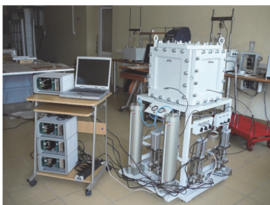
Рис. 3. Оборудование для определения деформационных характеристик в лабораторных условиях
