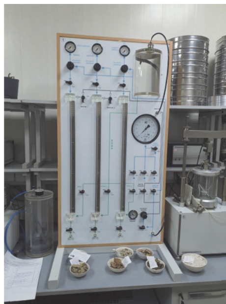
Рис. 2. Оборудование для определения фильтрационных свойств образцов шламов в лабораторных условиях
