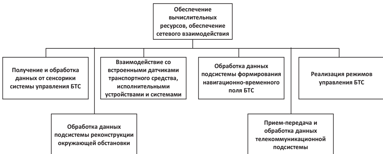
Рисунок 10 – Слоевая (проблемная) иерархия архитектуры вычислительного контура СУ БТС
