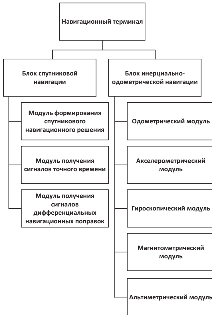
Рисунок 7 – Эшелонная иерархия архитектуры подсистемы формирования навигационно-временного поля
