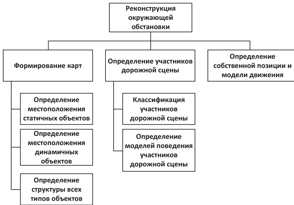
Рисунок 8 – Слоевая (проблемная) иерархия архитектуры подсистемы реконструкции окружающей обстановки
