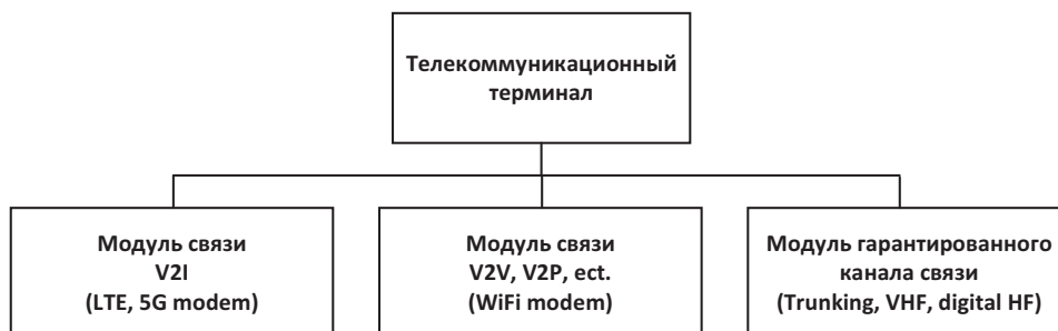
Рисунок 13 – Эшелонная (структурная) иерархия архитектуры телекоммуникационной подсистемы
