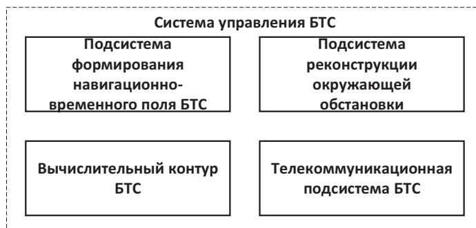
Рисунок 5 – Структура системы управления БТС
