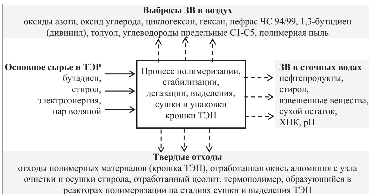
Рис. 2. Обобщенная схема получения линейного бутадиен-стирольного сополимера с позиции входных и выходных потоков, подлежащих инвентаризационному анализу
