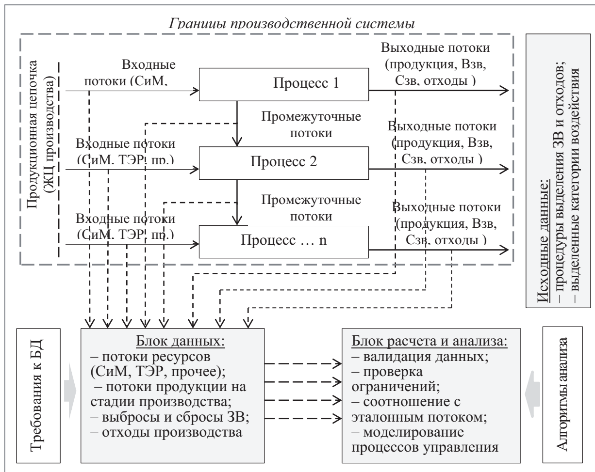
Рис. 1. Принципиальная блок-схема оценки воздействия жизненного цикла химического производства на экосистему по методу LCA
